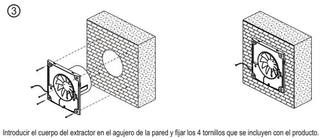
Introducir el cuerpo del extractor en el agujero de la pared y fijar los 4 tornillos que se incluyen con el producto.
